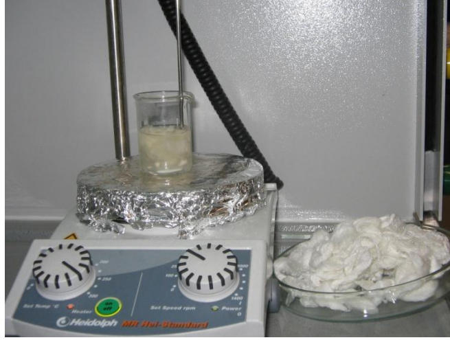
Şekil 3.13 : LiBr çözeltisi içinde ipek fibroini çözme işlemi
