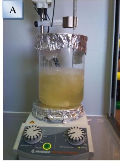
Şekil 3.11 : Zamk çıkarma (A) ve Yıkama işlemi (B)
