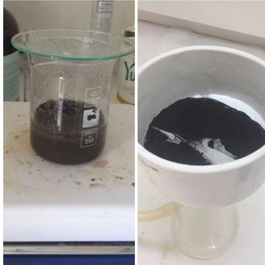
Şekil 3.3 Süzme ve yıkama işlemleri
