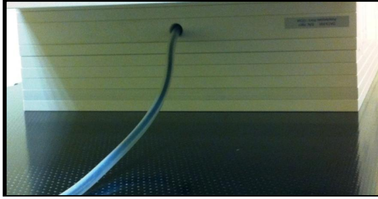
Şekil 3.5. Katı su fantomu ve iyon odasının yerleştirileceği hazne.
