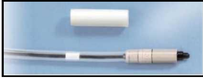
Şekil 3.4. Scanditronix-Wellhofer Marka CC04 Kompakt İyon Odası.
