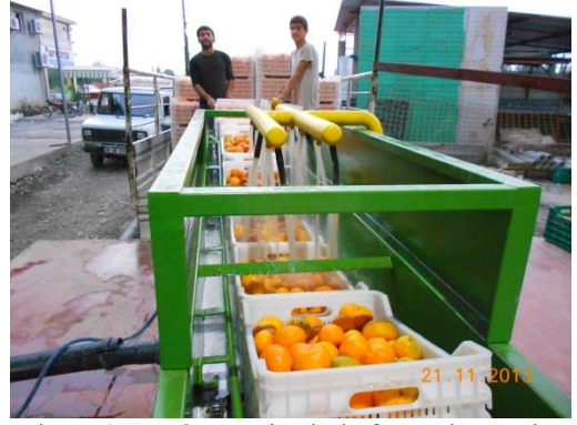
Duşlama (Drencher) ünitesinde fungusit uygulaması
