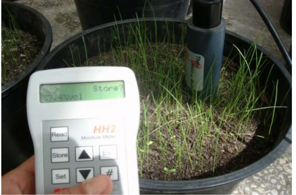
Şekil 3.13 Saksılarda TDR probu ile nem ölçümünün yapılması
