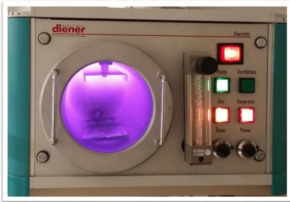
Şekil 3.5. Plazma polimerizasyon sistemin görüntüsü
