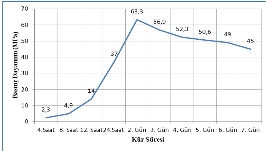
Şekil 4.41. 75 °C Farklı Kür Sürelerindeki Basınç Dayanımları
