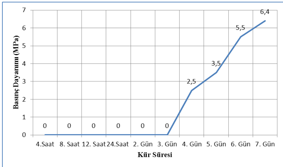
Şekil 4.38. 45 °C Farklı Kür Sürelerindeki Basınç Dayanımları
