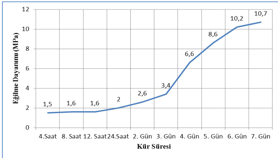
Şekil 4.31. 55 °C Farklı Kür Sürelerindeki Eğilme Dayanımları
