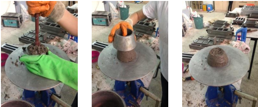
Şekil 3.3. İşlenebilirlik Deneyinde Kullanılan Yayılma Tablası
