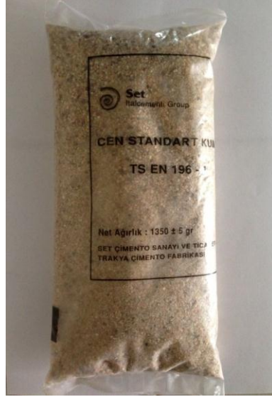
Şekil 3.1. Çalışmada kullanılan TS-EN 196-1 kum
