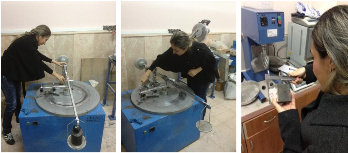
Şekil 3.12. Aşınma Cihazı (Böhme) ve Deney Anından Görüntü
