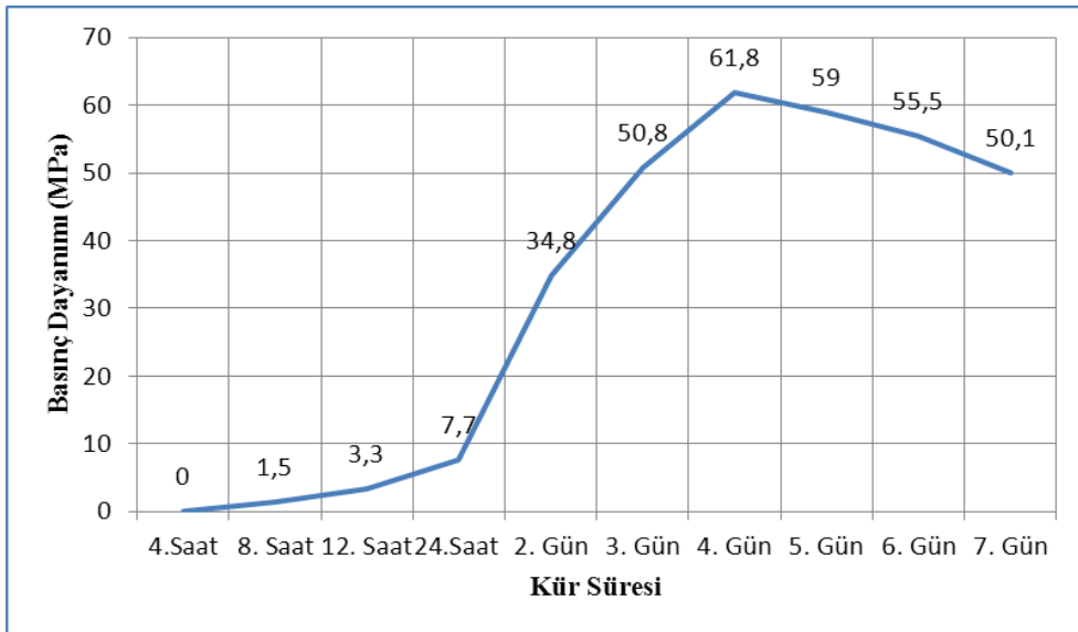
Şekil 4.40. 65 °C Farklı Kür Sürelerindeki Basınç Dayanımları
