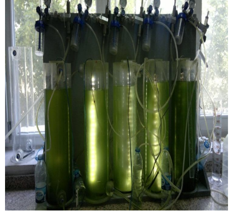
Resim 2.2. Lipit içeren mikroalglerin atıksu arıtımında kullanımı ve biyodizel potansiyellerinin araştırılması için kullanılan deney düzeneği
