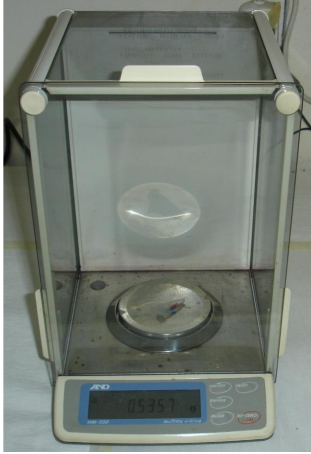
Resim 5.1. Kağıt şeriti içeren ependorf tüpünün hassas terazide tartılması.
