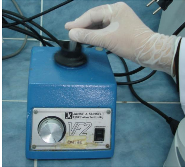
Resim 5.4. Örneklerin vortekste karıştırılması.
