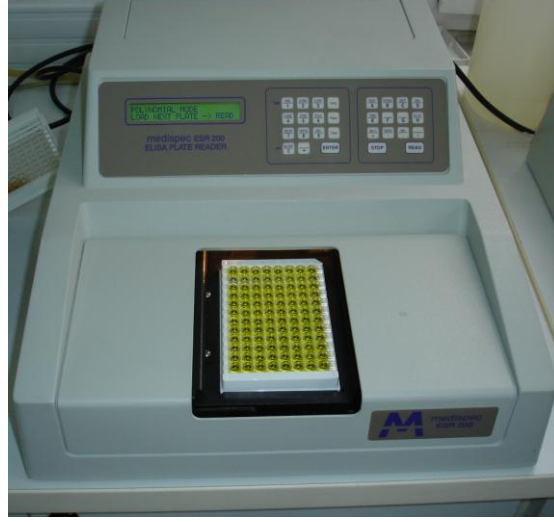
Resim 5.12 Deney prosedürü tamamlanmış mikrolakannın ELISA plate reader 'da okunması.
