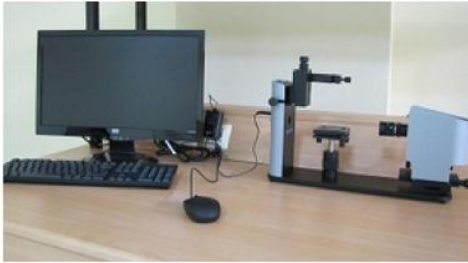
Şekil 2.6. Diatomitlerin temas açısı analizinde kullanılan KSV theta ışık optik goniometre model temas açısı ölçüm cihazı.
