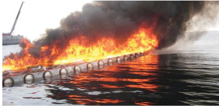
Şekil 1.6. Yağ döküntülerini temizleme amaçlı kullanılan yerinde yakma tekniğinin görünümü [29].
