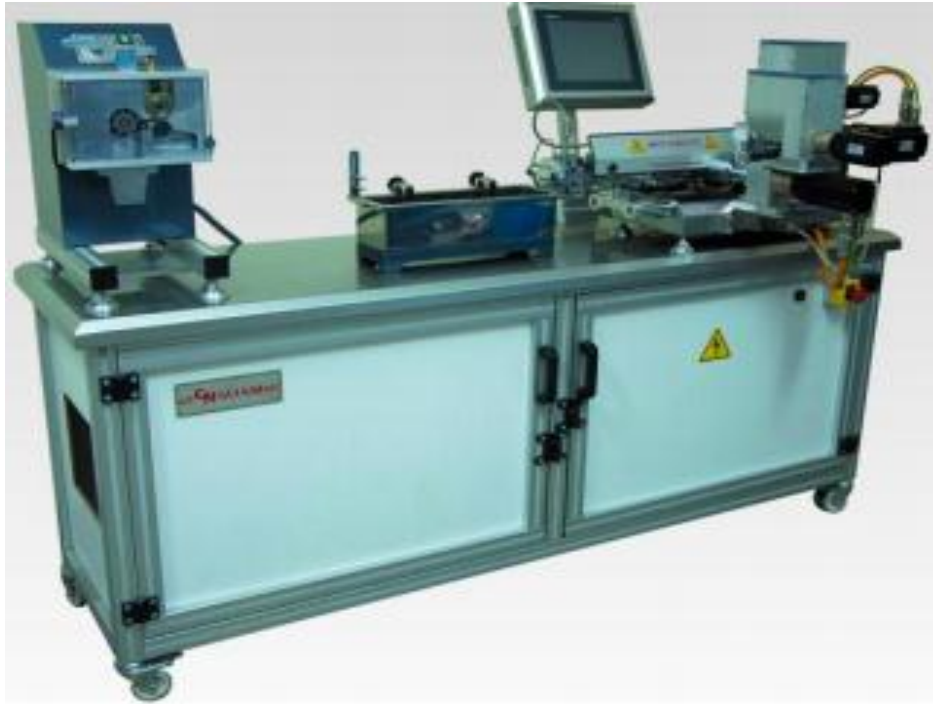
Şekil 2.5. Polipropilen/diatomit kompaundların üretiminde kullanılan Gülnar marka çift vidalı ekstrüder.
