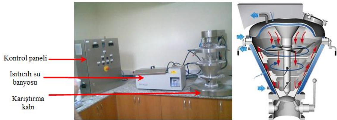
Şekil 2.4. Stearik asit ile kaplama işleminde kullanılan Cyclomix cihazının görünümü.
