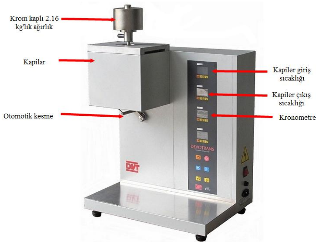
Şekil 2.7. Polipropilen/diatomit kompaundlarının MFI değerlerinin belirlenmesinde kullanılan Devotrans EA eriyik akış cihazı.
