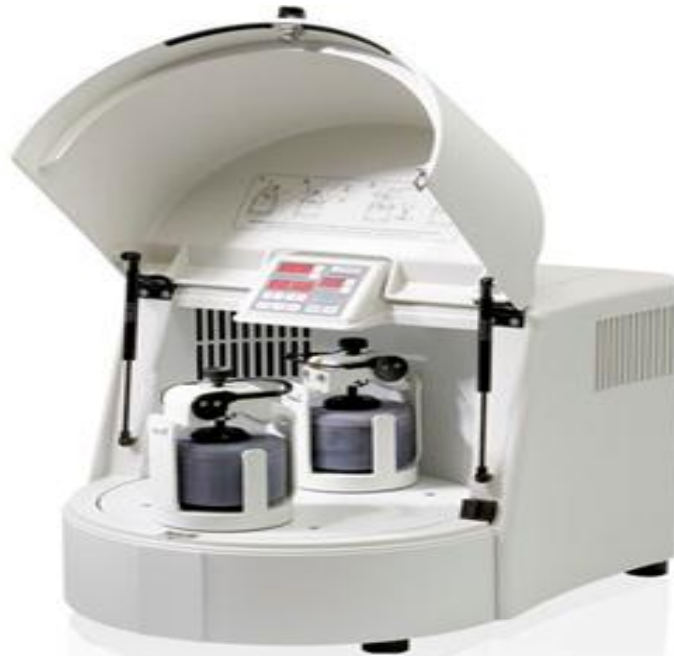
Şekil 2.3. Diatomitlerin öğütülmesinde kullanılan Fritsch Pulverisette 5 gezegensel bilyeli değirmen.
