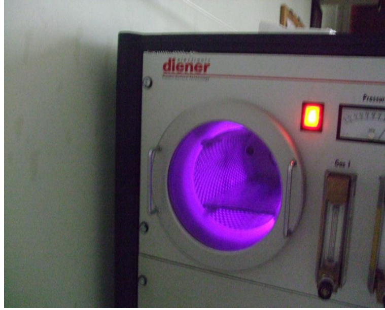
Şekil 3.4: Plazma işlemi sırasında oluşan reaksiyonun görünüşü
