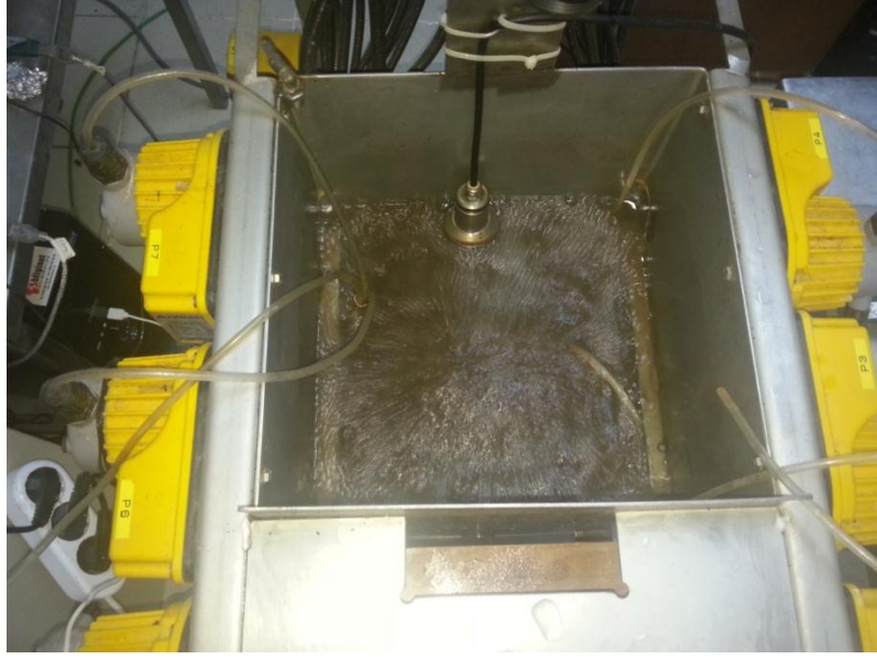
Şekil 3.8: MBR tankı işletme hali
