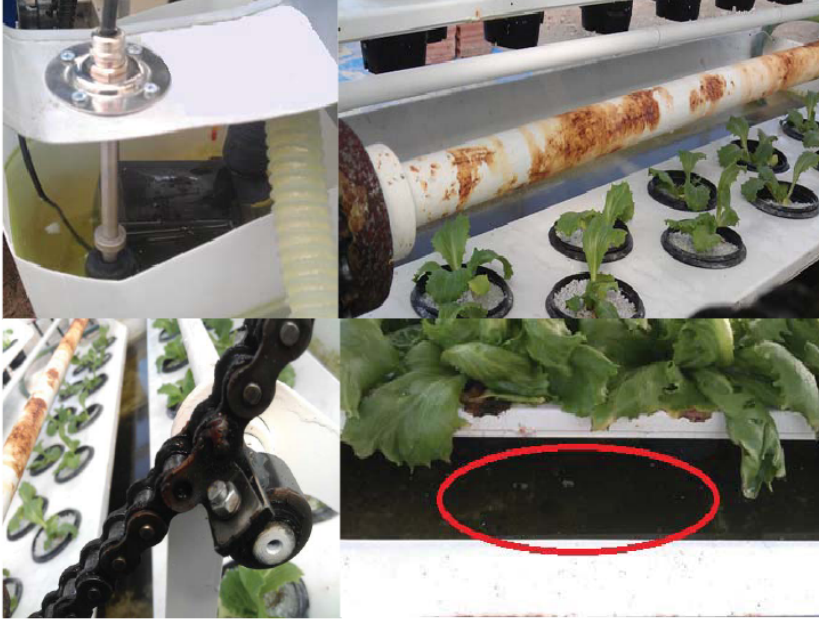
Şekil 4.16 Soldan sağa sırasıyla su seviye sensörü, paslanma sorunu, kopmadan önce zincir baklasının görünümü ve alt tankda alg oluşumu
