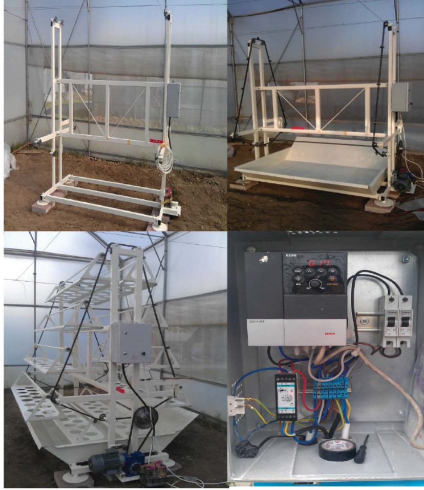
Şekil 3.4 Döner katlı sistemin sera içine kurulumu ve devrinin ayarlanması
