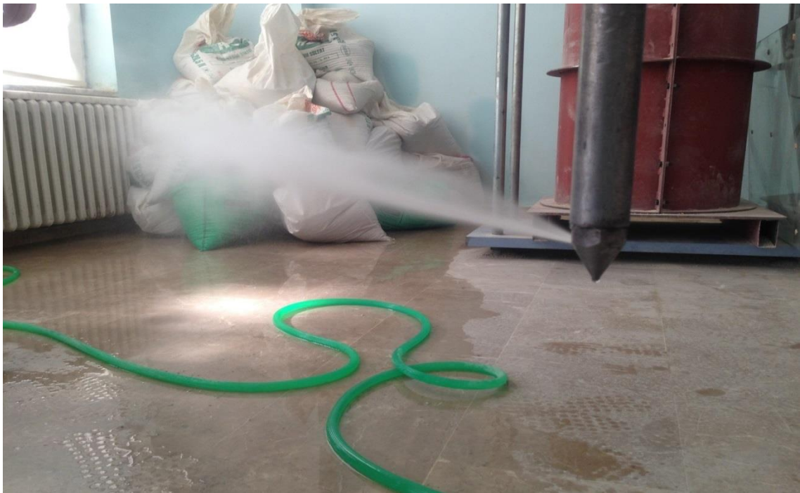
Şekil 3.12. 40 bar tek nozle su çıkışı
