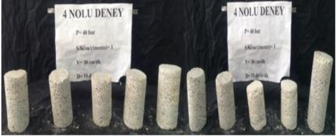
4 nolu kolon düzgün numuneler
