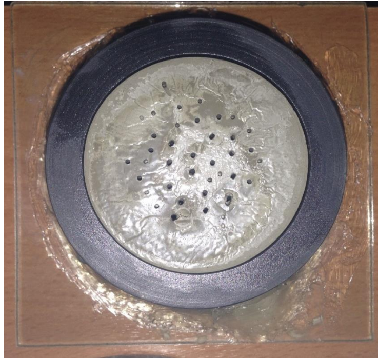
Şekil 3.31. Vicat deney sonrası numunenin son durumu
