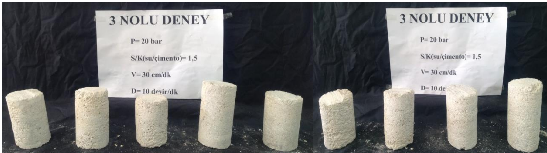
3 nolu kolon düzgün numuneler
