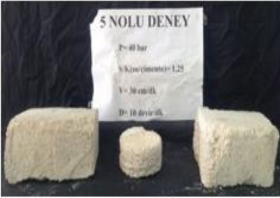
5 nolu kolon düzgün numuneler
