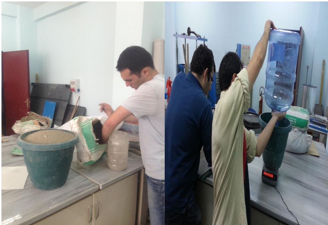
Şekil 3.20. İnce taneli çimento ve su, süspansiyon için tartılırken
