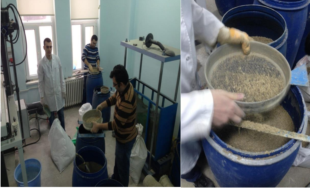
Şekil 3.41. Zemin numunelerinin kalıplara yerleştirilmesi
