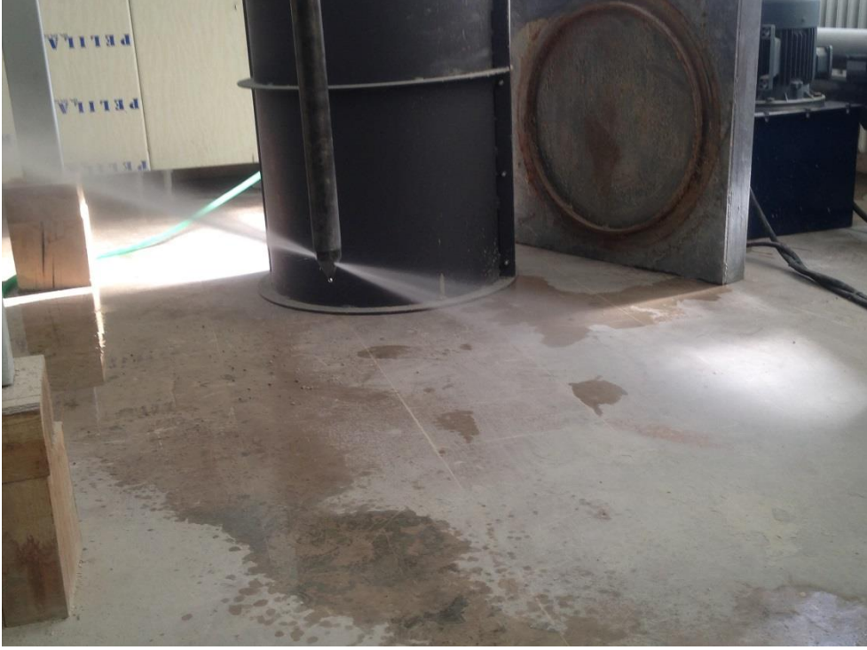
Şekil 3.9. 30 bar çift nozle su çıkışı
