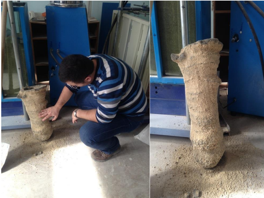
Şekil 3.16. Kalibrasyon sonrası üretilen başarılı kolonlar
