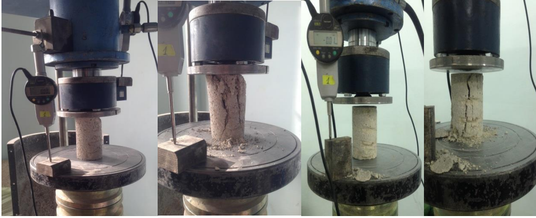
4 numaralı kolona ait iki silindirik Numune kırım öncesi ve sonrası
