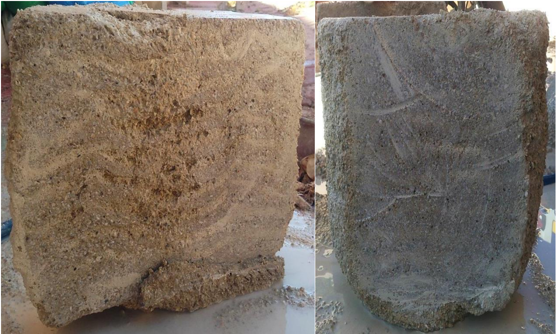
Şekil 4.18.5 nolu kolon boyuna kesit görünüşleri
