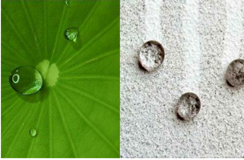
Şekil 13: Lotus çiçeğinden esinlenerek üretilmiş, su ve kir tutmayan malzeme
