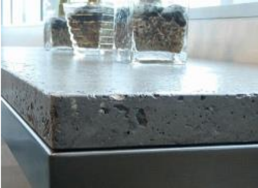
Şekil 32: Geri dönüştürülmüş kağıt, cam ve çimentodan üretilen panel
