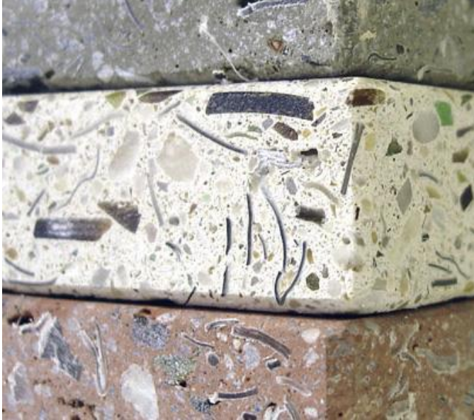
Şekil 29: Geri dönüştürülmüş cam ve fiberglas kullanılarak üretilen beton paneller
