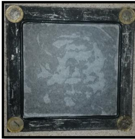
Şekil 3.3 O-ring ile çevrelenmiş olan kumaş ve reçine karışımının içene konulduğu bölüm
