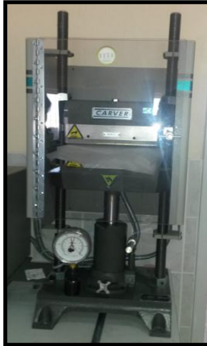
Şekil 3.1 Örneklerin kalıplanmasında kullanılan sıcaklık kontrollü pres
