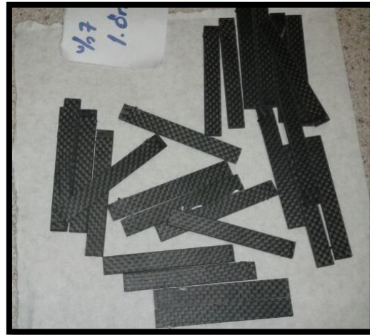
Şekil 3.4 Su jetinde kesilerek hazırlanan test numuneleri
