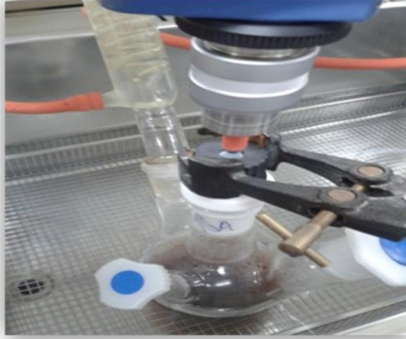
Şekil 5.5. PBI membran hazırlamak için kullanılan deney düzeneği
