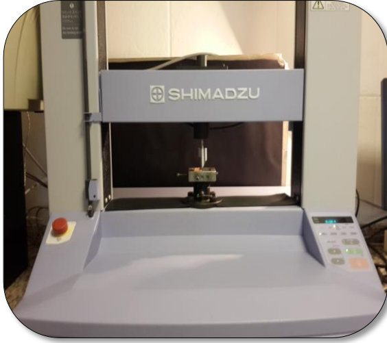
Resim 5.27. Shimadzu AGS-X test cihazı Resim 5.28. Makaslama testinin uygulaması
