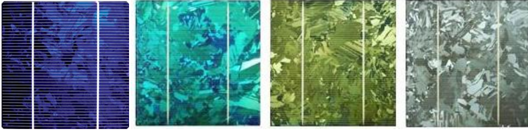
Şekil 3.8 : Polikristal fotovoltaik hücreler [39].
