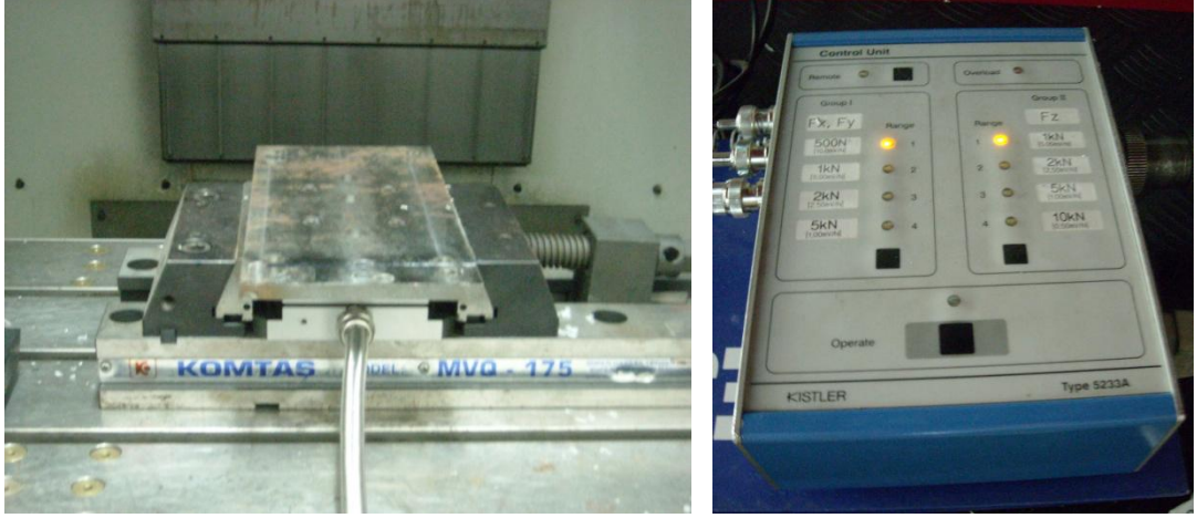
Şekil 3.4: Kuvvet ölçümlerinin yapıldığı dinamometre
