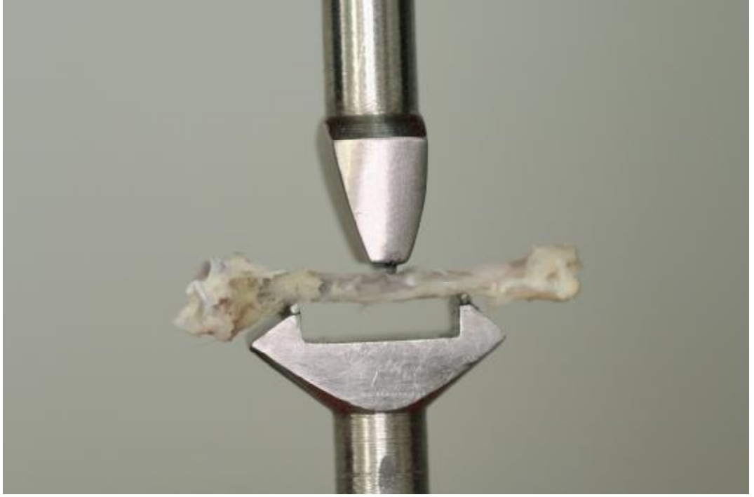
Şekil 3.3. Üç nokta eğme testi için hazırlanan düzenek.
