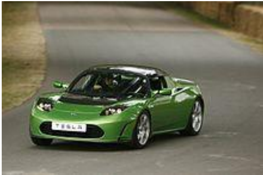
Şekil 1.12. The Tesla Roadster, 2008'de piyasaya çıktı, tamamen elektrikli 244 mi (393 km)'lik bir menzile sahiptir ve 2011'de üretimi durdu.
