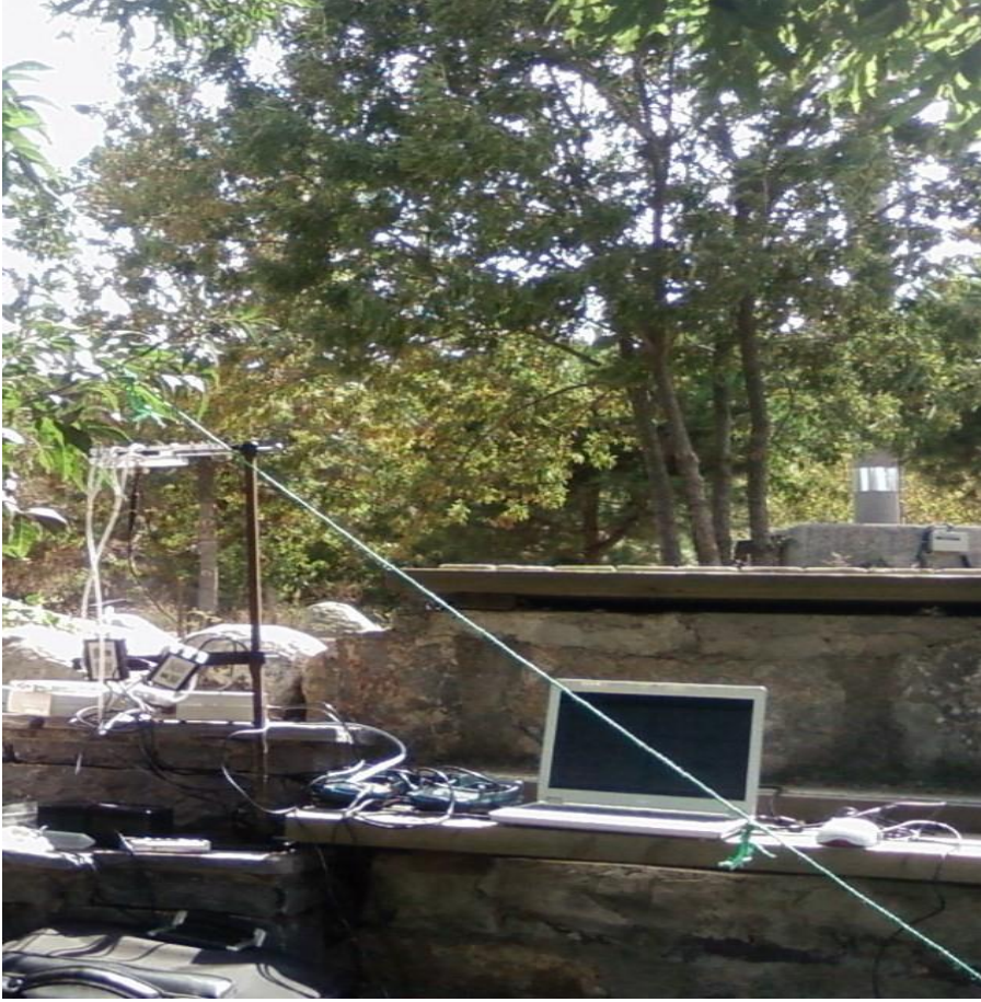
Şekil.3.7. Qubit Infrared Plant CO 2 Analysis cihazının arazide kullanımı.
