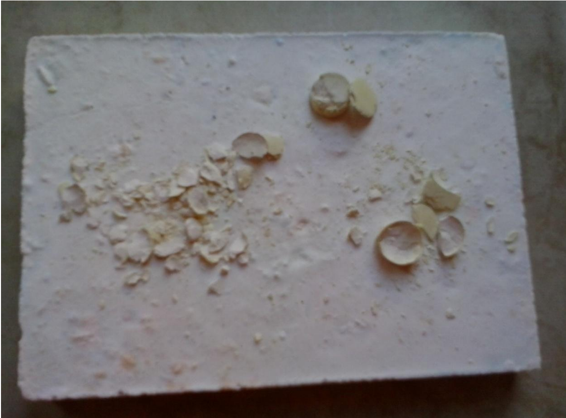
Şekil 8.21 : 1000°C'de sinterlenen TiO 2 tozlarının sinterleme sonrası fotoğrafı.
