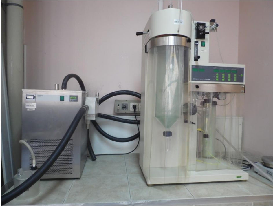
Şekil 7.2 : Deneysel çalışmalarda kullanılan püskürtmeli kurutucu.
