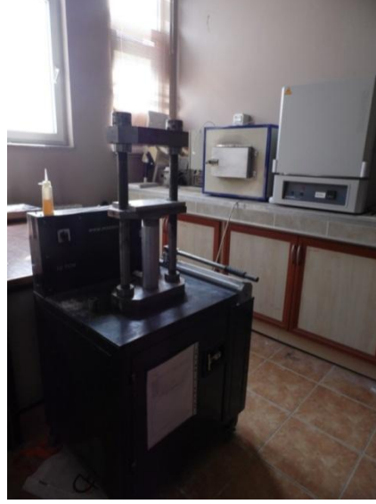
Şekil 7.3 : Deneysel çalışmalarda kullanılan hidrolik pres.
