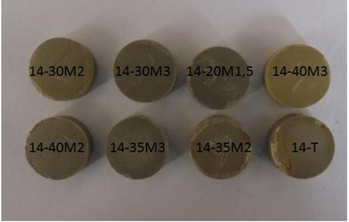
Şekil 8.27 : PVA katkılı TiO_2 granüllerin ve TiO_2 tozun 1400^\circ C 'de basınçsız sinterleme yöntemi ile sinterlenmesi sonucu elde edilen numunelerin fotoğrafı.
