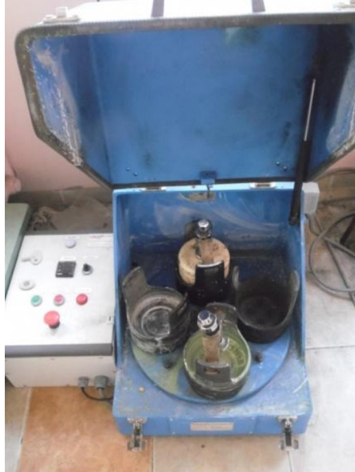
Şekil 7.1 : Deneysel çalışmalarda kullanılan gezegen tipi değirmen.
