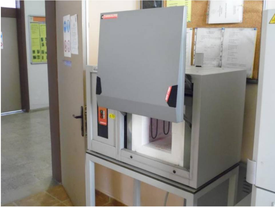
Şekil 7.5 : Deneysel çalışmalarda kullanılan sinterleme fırını.
