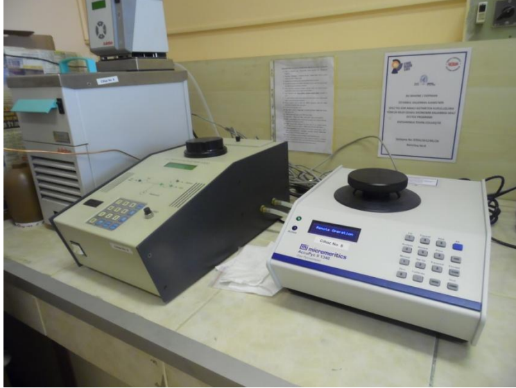
Şekil 7.9 : Deneysel çalışmalarda kullanılan gaz piknometresi
