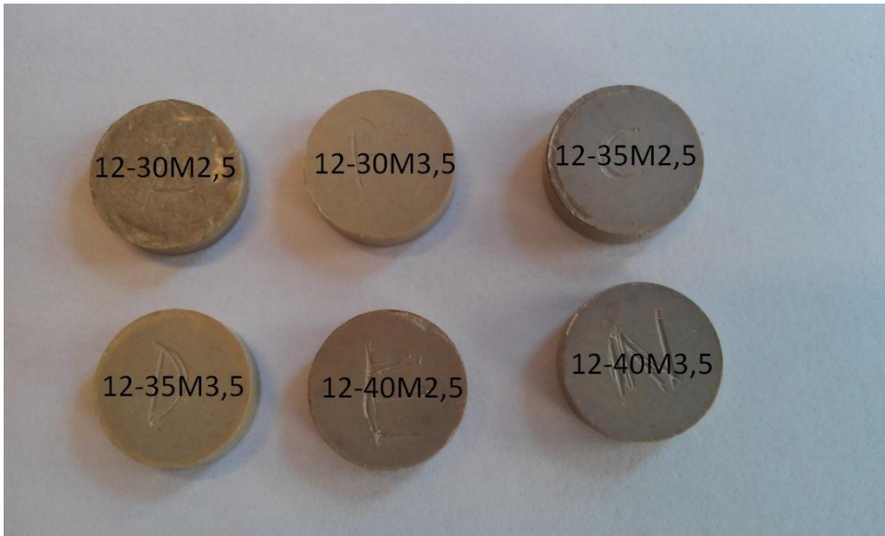
Şekil 8.26 : PVA katkılı TiO 2 granüllerin 1200°C’de basınçsız sinterleme yöntemi ile sinterlenmesi sonucu elde edilen numunelerin fotoğrafı.
