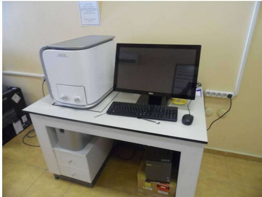
Şekil 7.11 : Deneysel çalışmalarda kullanılan taramalı elektron mikroskobu.
