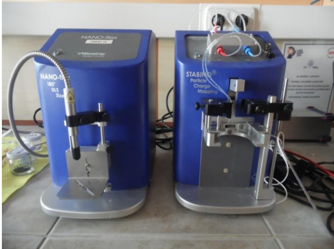
Şekil 7.6 : Partikül boyut, boyut dağılımı ve zeta potansiyeli ölçümü cihazı.
