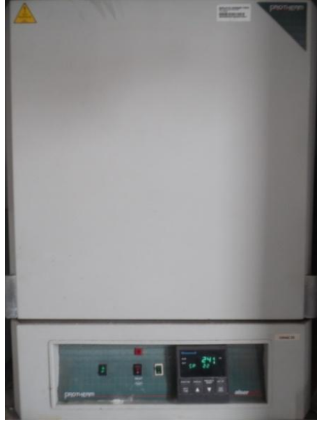
Şekil 7.4 : Deneysel çalışmalarda kullanılan bağlayıcı giderme fırını.
