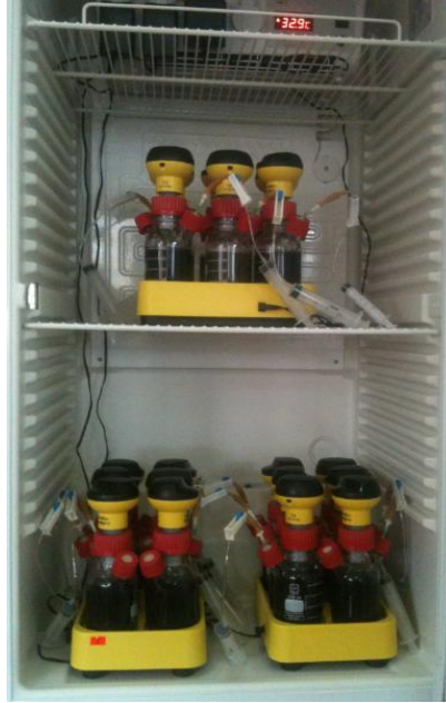
Şekil 3.2 Kesikli reaktör (Oxipop C şişeler)
