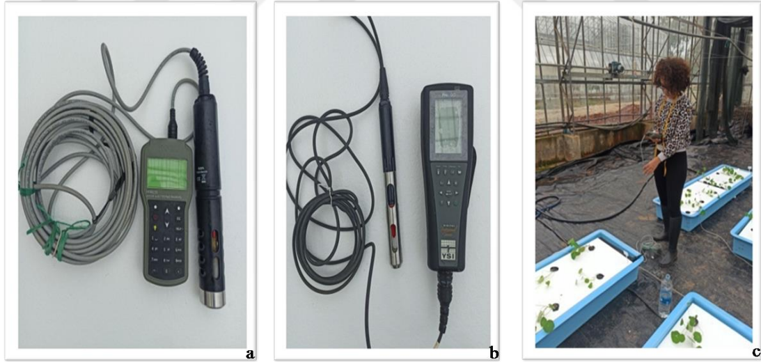
Şekil 3.11. pH metre (a); dijital oksijen metre (b); ve solüsyon ölçümlerinden genel bir görünüm (c)
