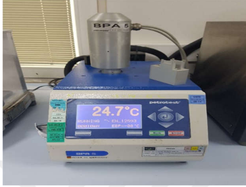
Şekil 18. Örneklerin analizinde kullanılan fraass kırılma noktası tayin cihazı
