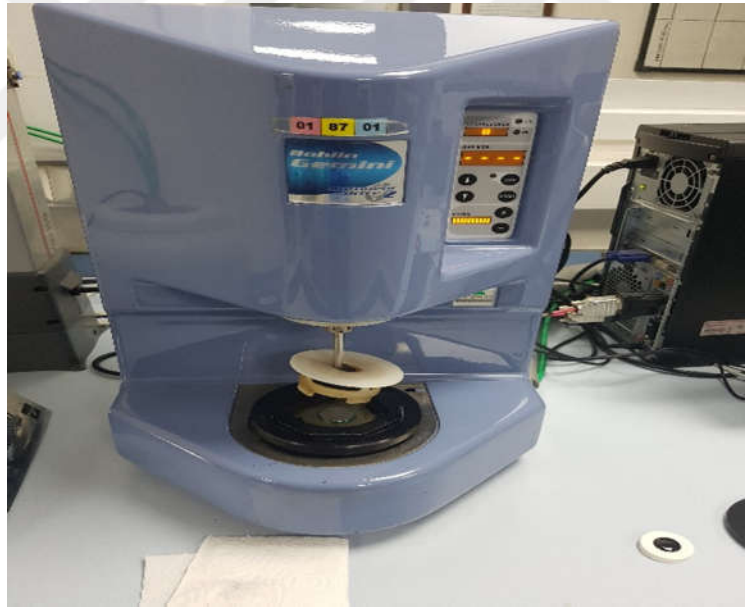
Şekil 17. Örneklerin Analizinde Kullanılan Dinamik Kesme Rehometre (DSR) Cihazı
