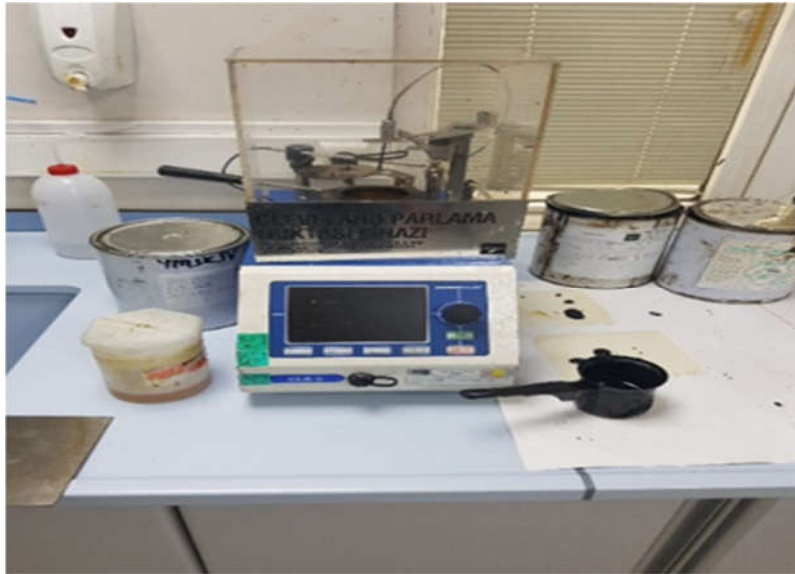
Şekil 15. Örneklerin analizinde kullanılan parlama noktası tayin cihazı
