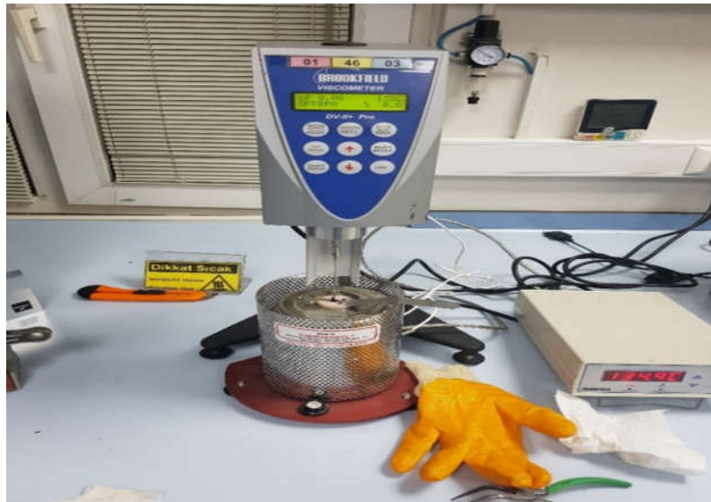
Şekil 16. Örneklerin analizinde kullanılan viskozite cihazı
