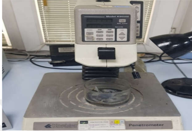
Şekil 12. Örneklerin analizinde kullanılan penetrasyon cihazı
