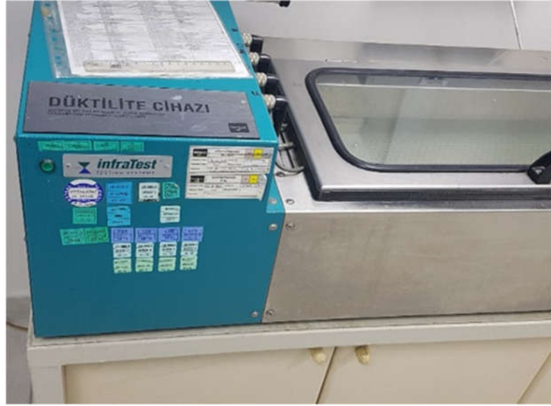
Şekil 14. Örneklerin analizinde kullanılan düktilite cihazı
