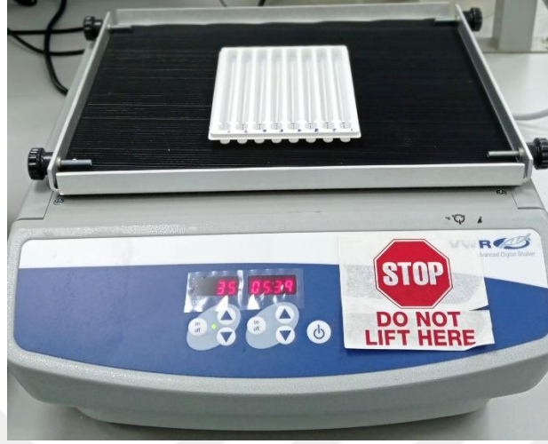
Şekil 3-3. İnkübasyonda kullanılan shaker cihazı (VWR, San Diego, ABD).
