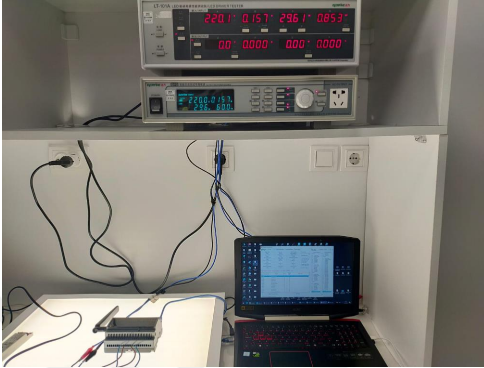
a) LT-101A LED sürücü test cihazının ölçtüğü elektriksel değerler
