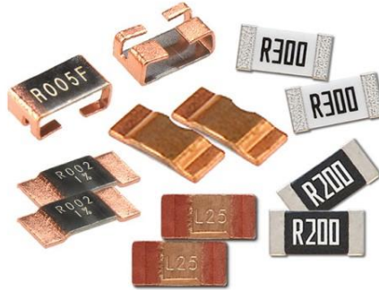
Şekil 2.25. Akım ölçümünde kullanılan şönt direnç tipleri
