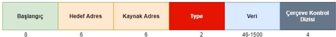
Şekil 2.8. Ethernet çerçeve yapısı
