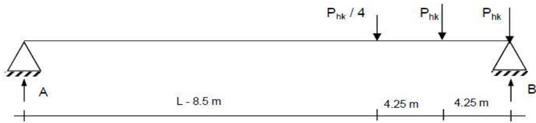
Şekil 2.2 H 30 -S 24 standart kamyon yükünün eğilme momenti için basit kiriş üzerindeki elverişsiz yerleşimi
