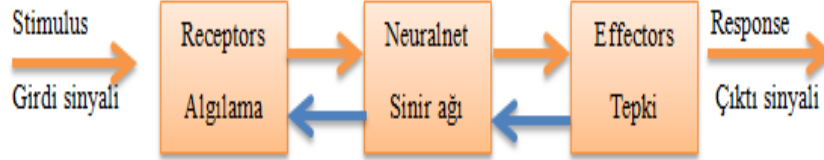
Şekil 2. Biyolojik sinir sistemi blok diyagramı (Bahadır, 2013).
