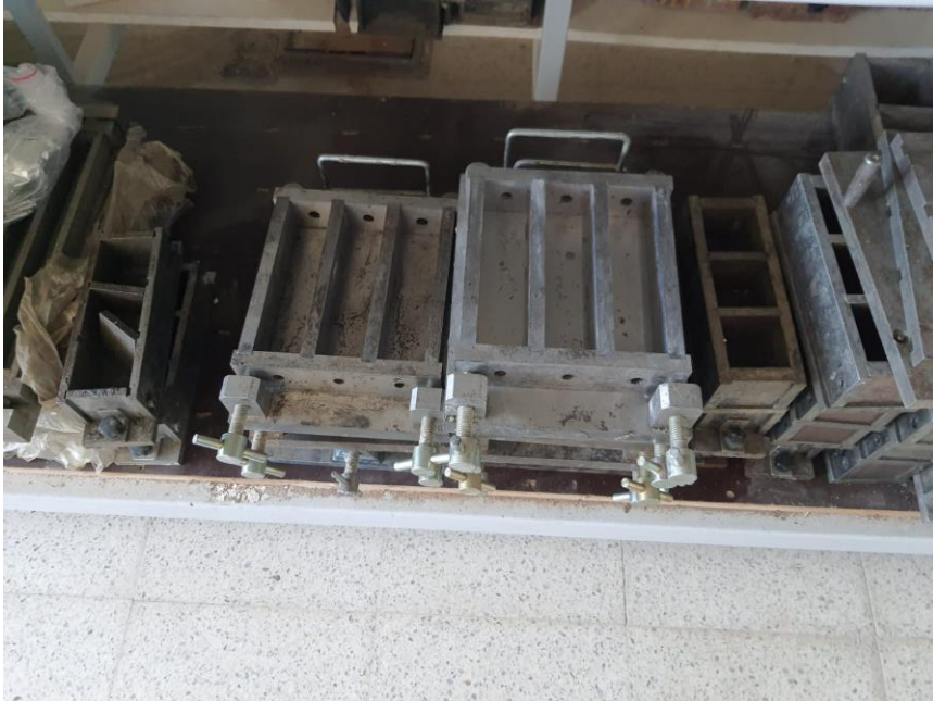
Şekil 3.2.3. Beton dökme kalıpları.
