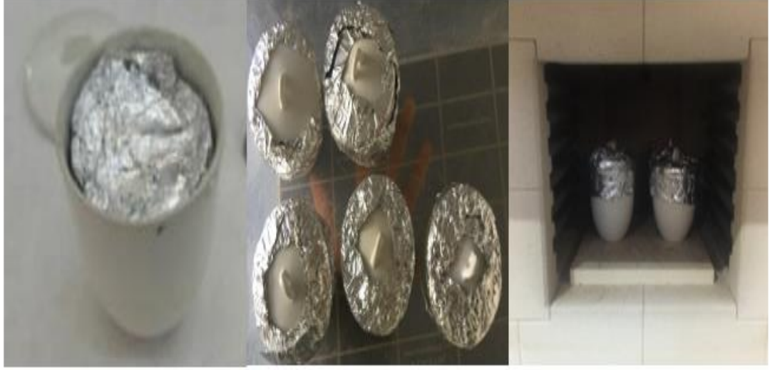
Şekil 3.10. Krozede hazırlanan ve kül fırınında torefiye edilen biyokütleler
