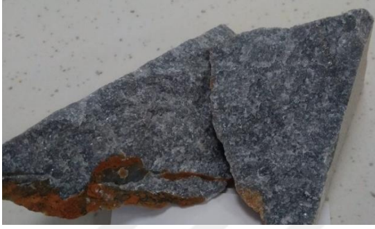
Resim 4.31 TP-1 (Tekpalamur tepe) kodlu örneğin kalsinasyondan önce (sol resim) ve kalsinasyondan sonra (sağ resim) ki görünümü.
