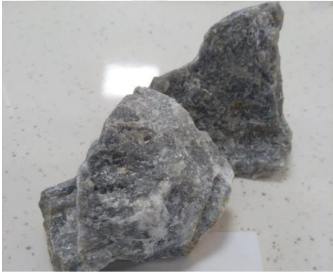
Resim 4.25 BA-2 (BA mermer) kodlu örneğin kalsinasyondan önce (sol resim) ve kalsinasyondan sonra (sağ resim) ki görünümü.
