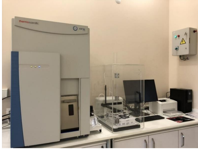
Resim 3.10 İndüktif Eşleşmiş Plazma Kütle Spektrometresi (ICP-MS) analiz cihazı (ESOGÜ).
