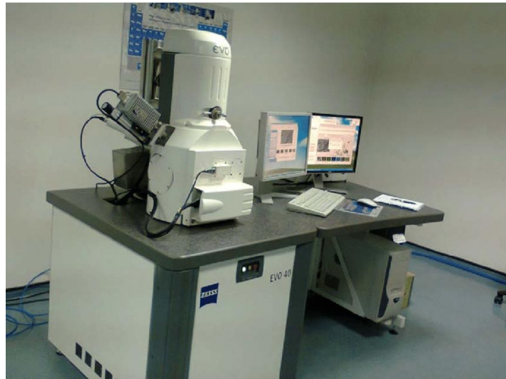
Resim 3.8 Taramalı elektron mikroskop (SEM).
