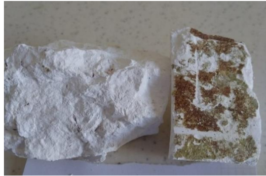
Resim 4.29 BT-4 (Olimar mermer) kodlu örneğin kalsinasyondan önce (sol resim) ve kalsinasyondan sonra (sağ resim) ki görünümü.
