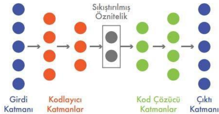
Şekil 11. Derin Oto-kodlayıcı ağ yapısı [42]
