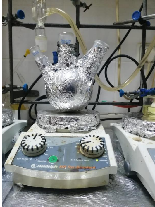
Şekil 74 Aktif Karbon ve NPAg'ün Üç Boyunlu Cam Balonda Manyetik Karıştırıcıda Karıştırılması
