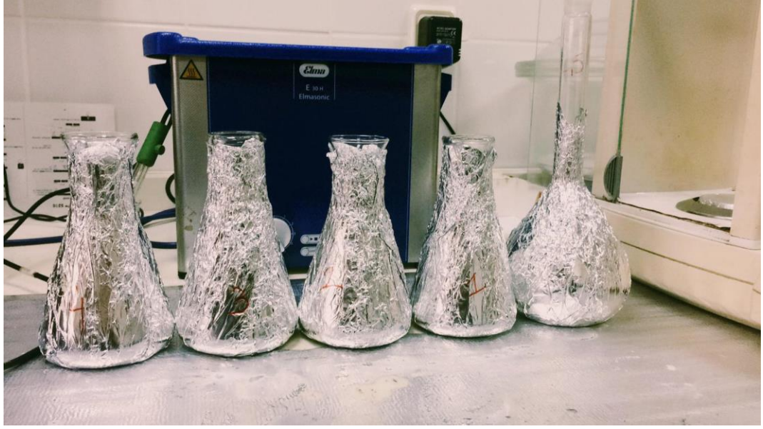
Şekil 73 Farklı Oranlarda (0,5g ve 1g) Hazırlanmış Biamgümüş Nitrat ( [\text{Ag}(\text{NH}_3)_2]\text{NO}_3 ) Karışımları
