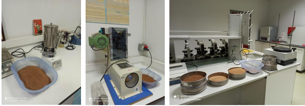
Şekil 34 Fındık Kabuğu Öğütme ve Eleme İşlemleri
