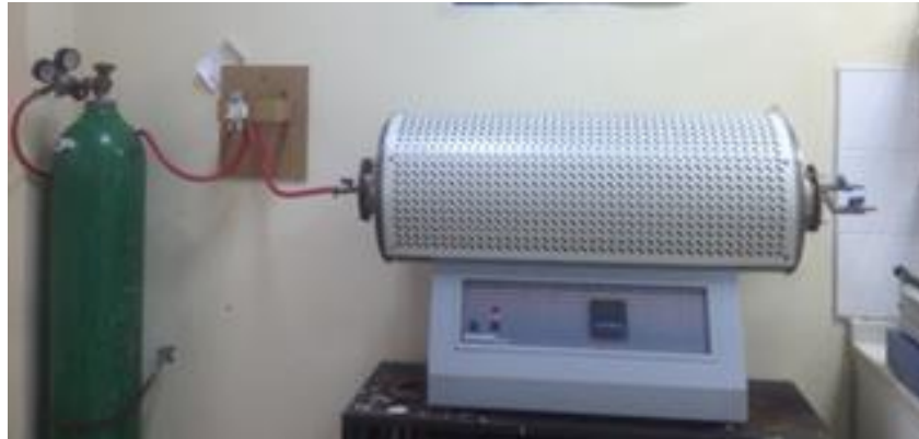
Şekil 38 Protherm PFT 12-105-900 Model Tüp Fırında Karbonizasyon
