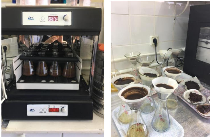
Şekil 36 Çalkalamalı İnkübatörde Kimyasal Aktivasyon İşlemi ve Sonrasında Süzme İşlemi Yapılarak Hammaddeden Kimyasalın Uzaklaştırması
