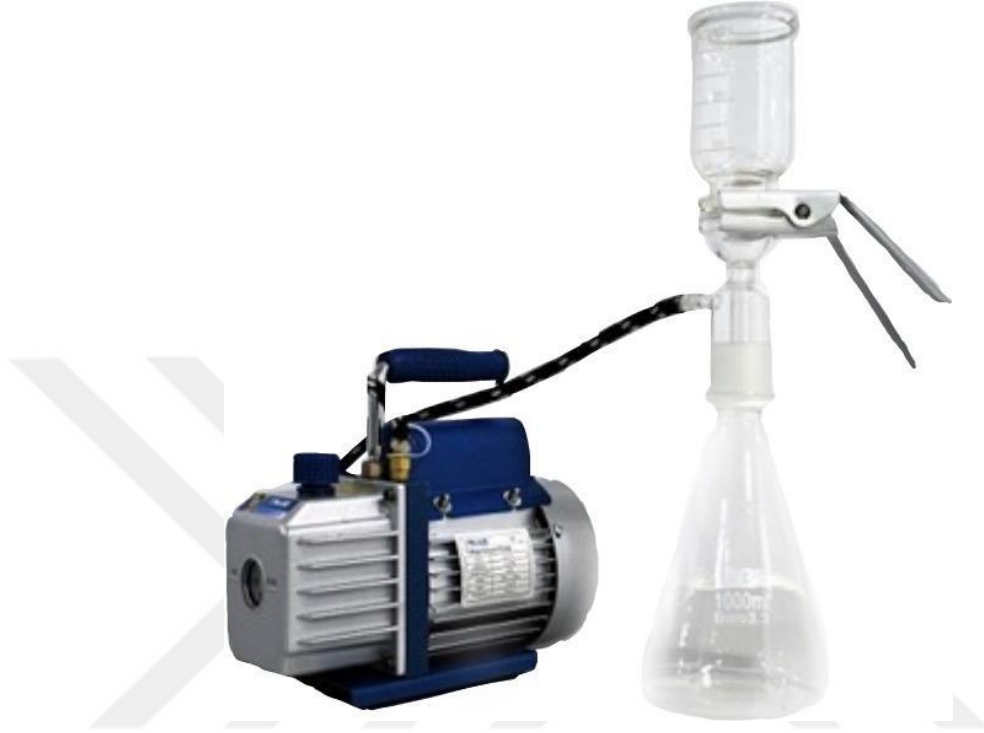
Şekil 2.3 : Membran filtrasyon sistemi.
