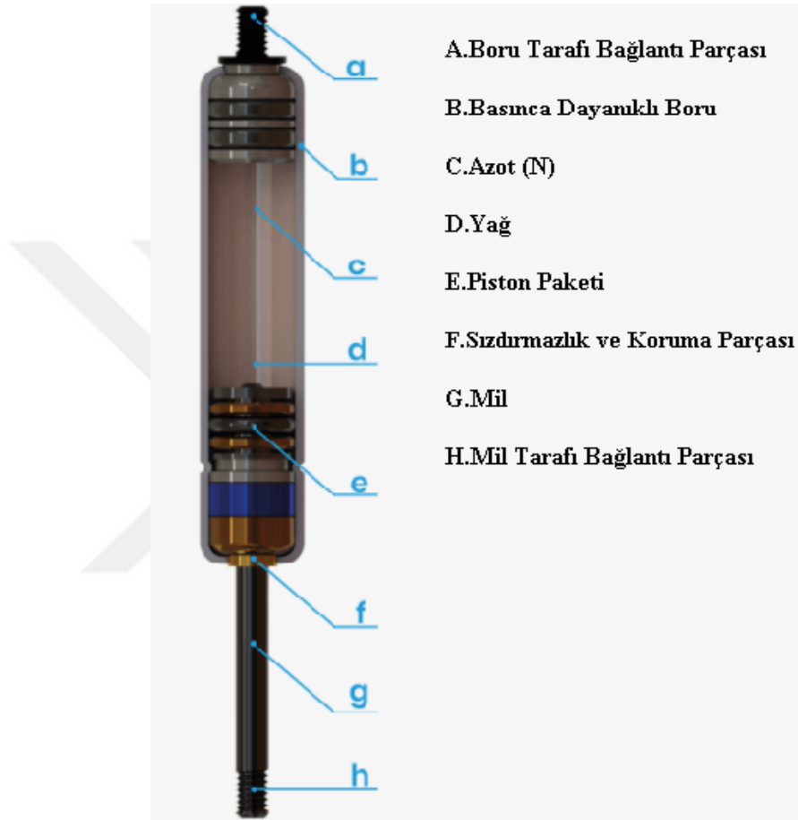
Şekil 2.43. Gazlı Amortisör Bileşenleri
