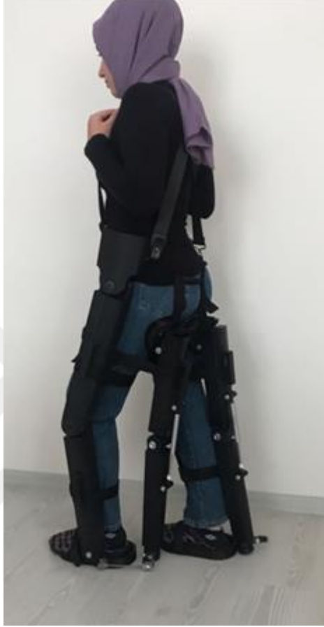
Şekil 4.11. Geliştirilen oturma yardımcılı giyilebilir dış iskelet yürüme sisteminin yürüme döngüsü sırasındaki pozisyonu
