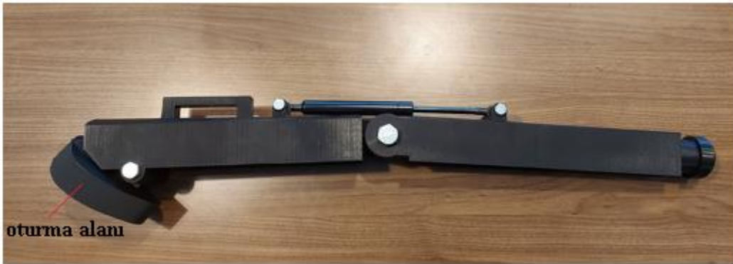
Şekil 4.5. Oturmaya yardımcı kısım montaj hali
