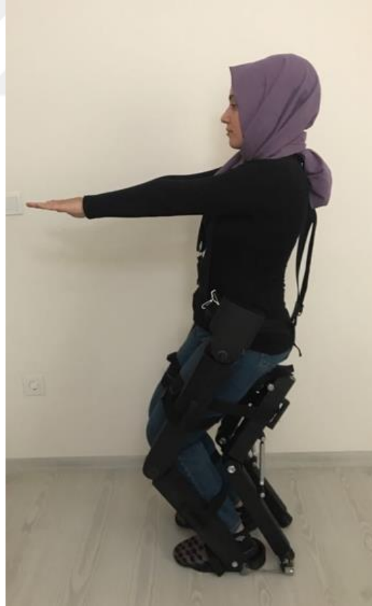
Şekil 4.15. Geliştirilen oturma yardımcı giyilebilir dış iskelet yürüme sisteminin oturma durumundaki pozisyonu
