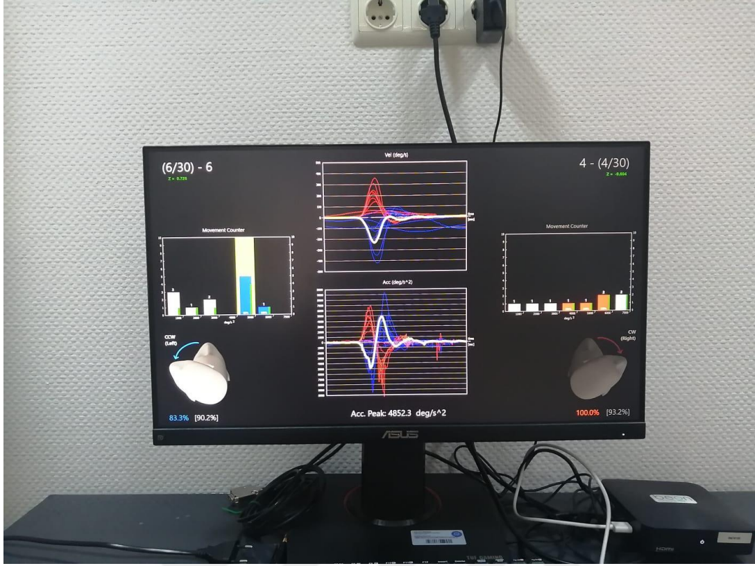
Şekil 3.7 fHIT ekranının test sırasındaki durumu
