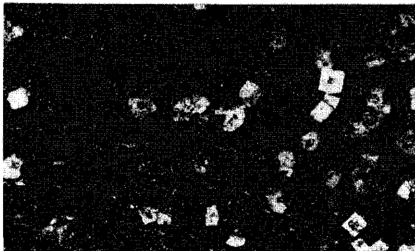
شکل ۵-۳ پوشش تشکیل شده بر روی نمونه‌ها (بزرگنمایی 200\times )
