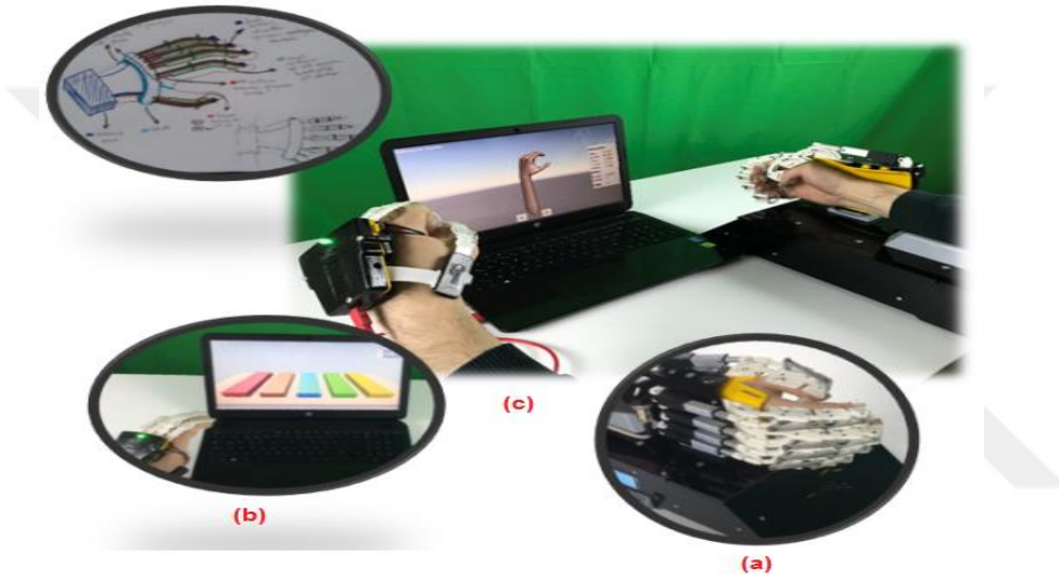
Resim 2: Eli Dıřardan Destekleyen Robotik El Rehabilitasyon Sisteminin Bileřenleri. (a) Harici el iskelet sistemi, (b) akıllı eldiven sistemi, (c) el rehabilitasyon uygulama yazılımı (Bařpınar ve ark., 2021)
