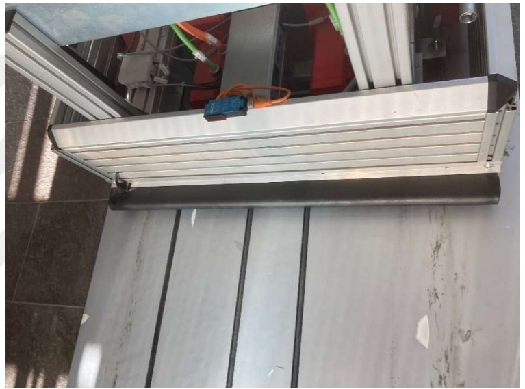
Şekil 4.4. Elektrikli araç üzerine sensör montajı
