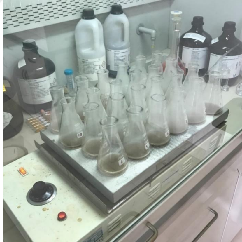
Şekil 3.12 Sediment yaş yakma çalışmalarından bir görünüm
