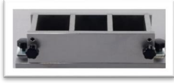
a) 50 x 50 x 50 mm boyutlarında harç kalıpları
