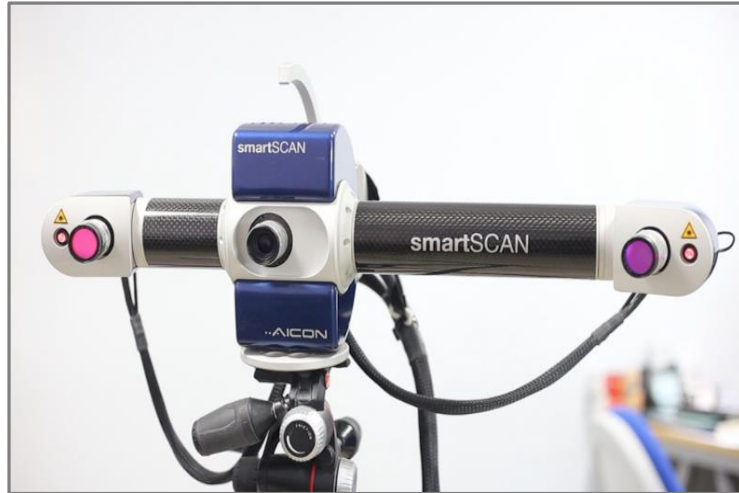
Şekil 4.5. 3B Optik tarama cihazı [58].
