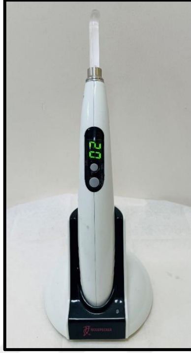
Şekil 3.5. Kompomer polimerizasyonda kullanılan ışın cihazı
