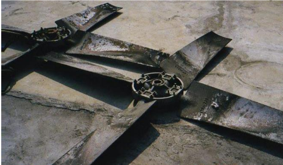
Şekil 6.1. Uygulama öncesi alüminyum fan kanatları örnekleri (Encon Group, 2019)
