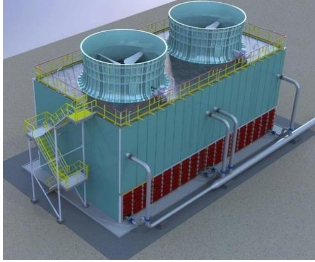
Şekil 3.3. Aksiyel fanlı cebri çekişli soğutma kulesi görünümü (URL-4)
