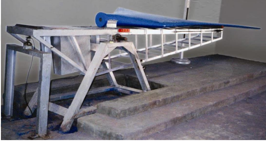
Şekil 4.8. Statik balans test düzeneği (Encon Group, 2019)
