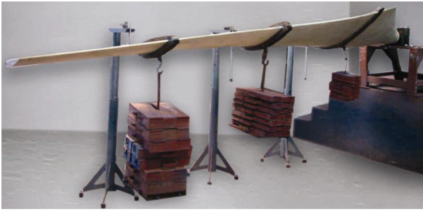
Şekil 4.9. Yük testi düzeneği (Encon Group, 2019)
