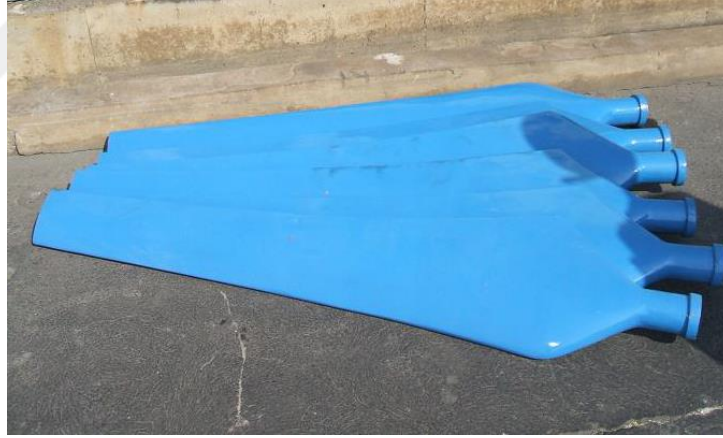
Şekil 4.1. Epoksi fiber glass aksiyel fan kanatları görünümü (Encon Group, 2019)
