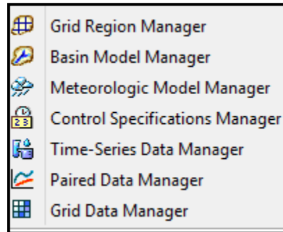
Şekil 3.8 HEC-HMS havza modelinde bileşenler (HEC-HMS, v.4.1.)
