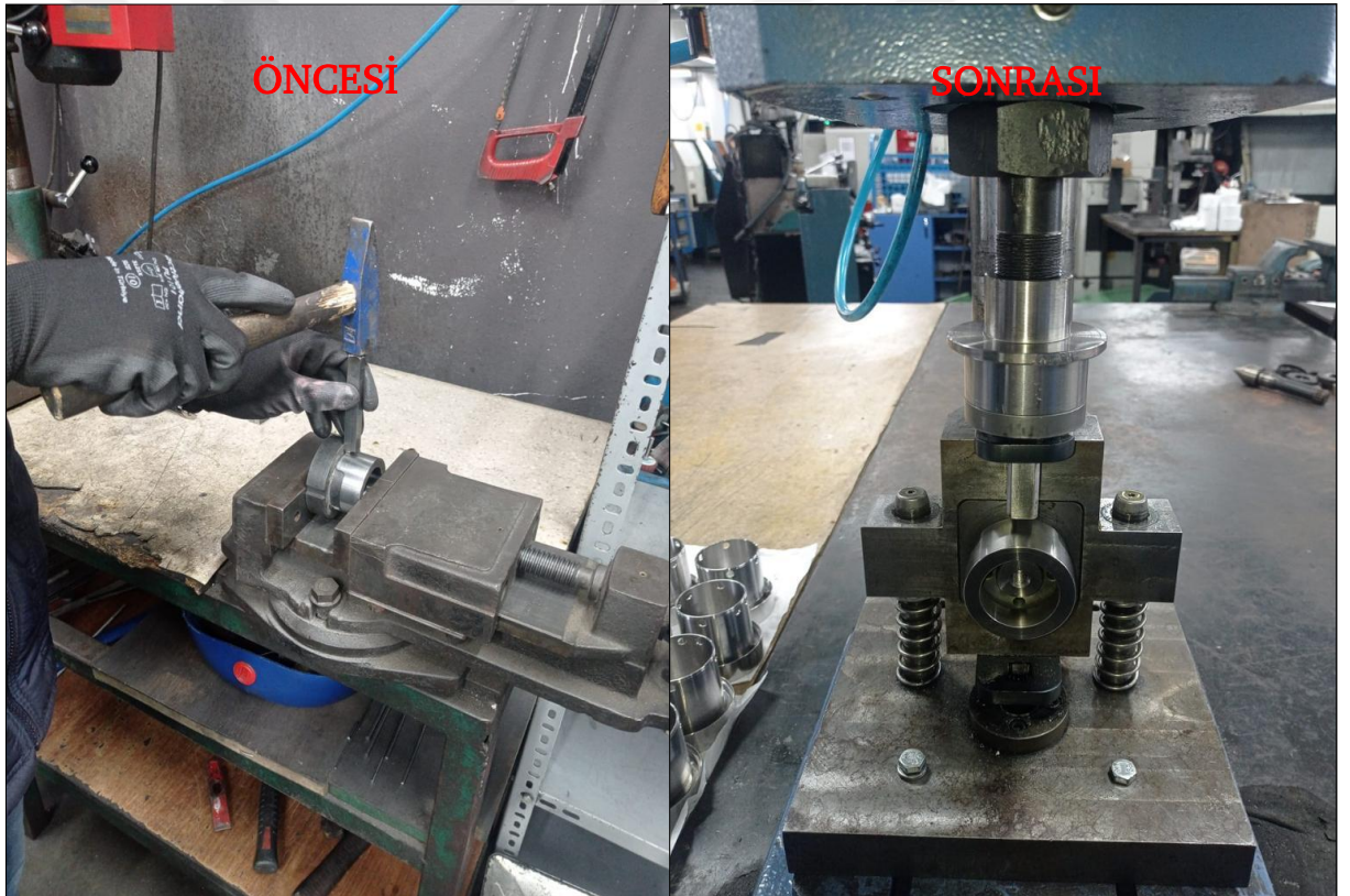
Şekil 6.5 Ezme operasyonu iyileştirme öncesi ve sonrasına ait görsel
