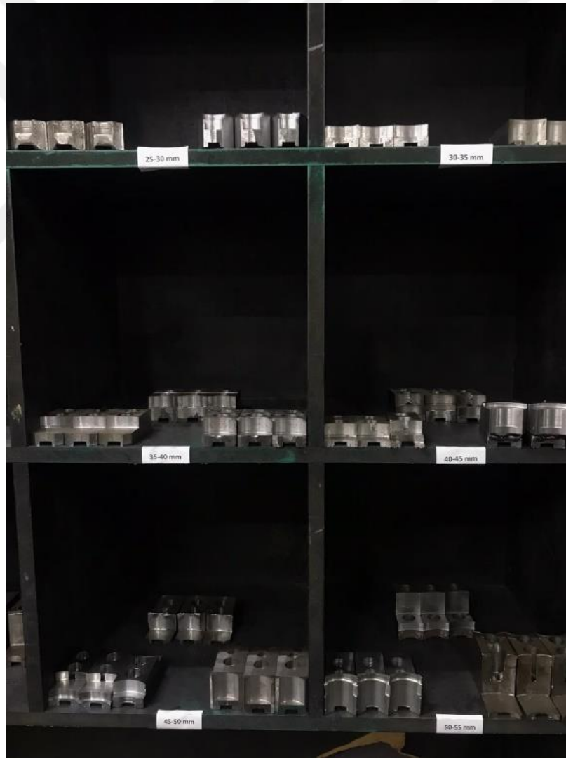
Şekil 6.7 Ayna ayakları rafının düzenleme sonrası görüntüsü
