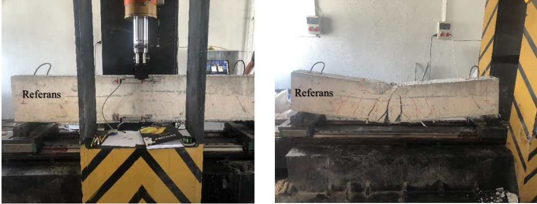
Resim 4.1 Referans Kirişi, Yükleme Deneyi Öncesi ve Sonrası.
