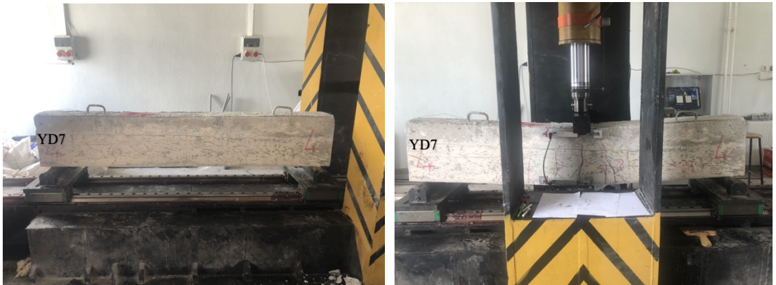
Resim 4.3 YD7'ye Ait Kiriş, Yükleme Deneyi Öncesi Ve Sonrası.
