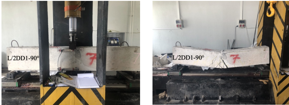
Resim 4.4 L/2DD1-90° deneyine ait kiriş, yükleme deneyi öncesi ve sonrası
