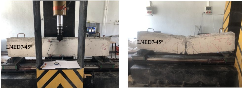
Resim 4.9 L/4ED7-45° Deneyine Ait Kiriş, Yükleme Deneyi Öncesi Ve Sonrası.
