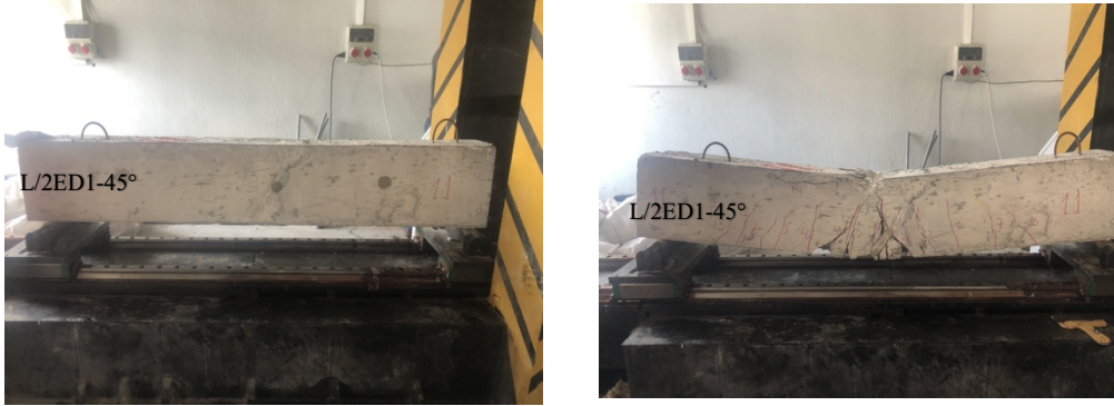
Resim 4.6 L/2ED1-45° Deneyine Ait Kiriş, Yükleme Deneyi Öncesi Ve Sonrası.
