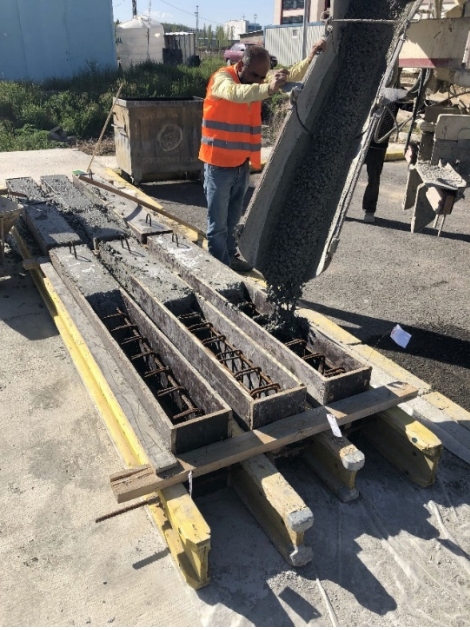
Resim 3.2 Kiriş Numunelerde Soğuk Derz Uygulaması.
