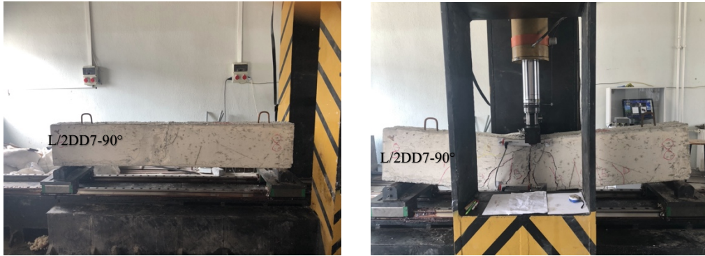
Resim 4.5 L/2dd7-90° Deneyine Ait Kiriş, Yükleme Deneyi Öncesi Ve Sonrası.
