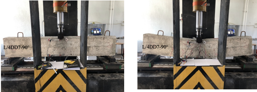
Resim 4.11 L/4DD7-90° Deneyine Ait Kiriş, Yükleme Deneyi Öncesi Ve Sonrası.
