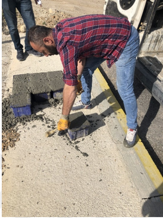
Resim 3.4 Basınç Dayanımı Deneyleri İçin Küp Numune Alımı.
