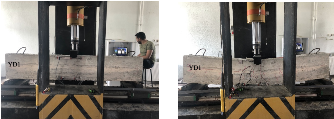
Resim 4.2 Yd1’e Ait Kiriş, Yükleme Deneyi Öncesi Ve Sonrası
