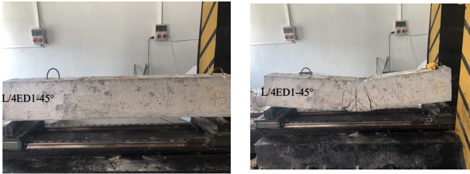
Resim 4.8 L/4ED1-45° Deneyine Ait Kiriş, Yükleme Deneyi Öncesi Ve Sonrası.
