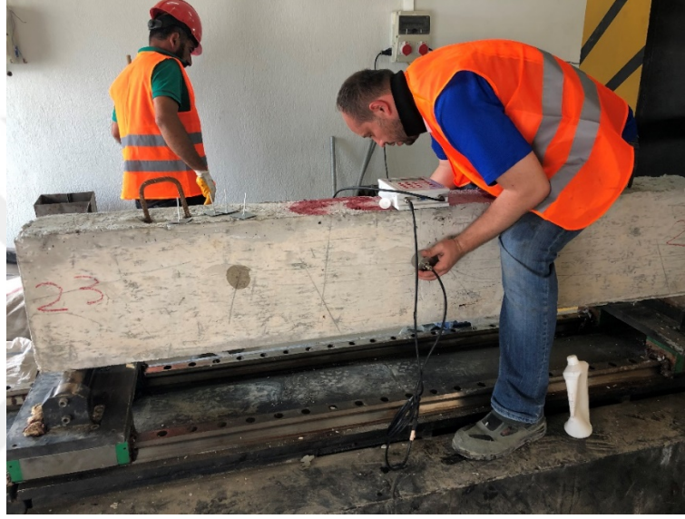
Resim 3.3 Ultrases Geçiş Süresi Deneyi.
