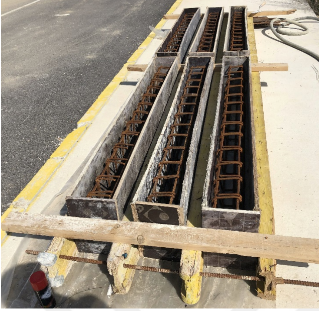
Resim 3.1 Kiriş Numune Hazırlanışı.
