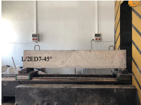
Resim 4.7 L/2ED7-45° Deneyine Ait Kiriş, Yükleme Deneyi Öncesi Ve Sonrası
